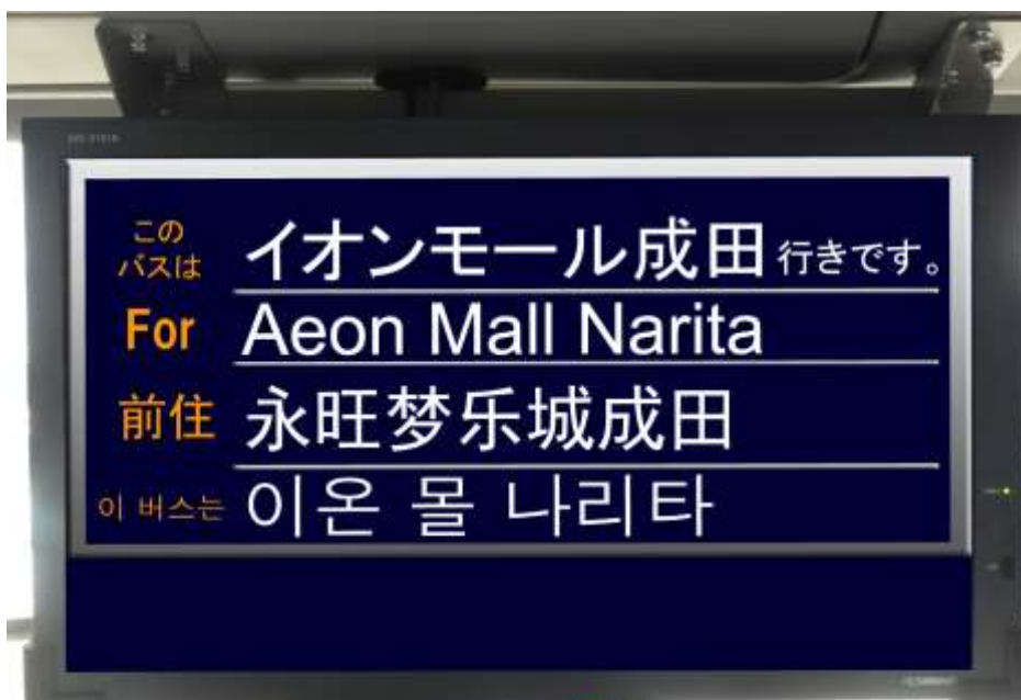
搭載した27インチ大型停留所名表示液晶モニター（一例）
